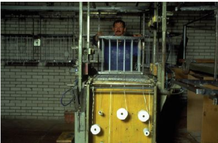
Figuur 2-4: Katoenen lonten worden op een rek gespannen.
