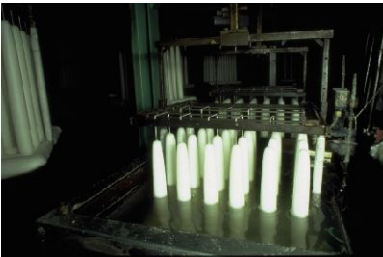
Figuur 2-6: Per dompeling in de vloeibare paraffine van 80 °C groeit de kaars 1 mm in dikte.
