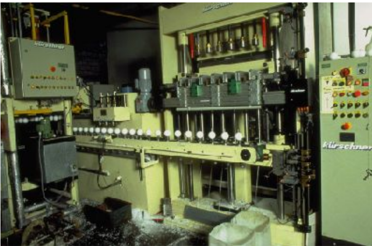
Figuur 2-14: Overzicht van een machine waarin bolkaarsen worden geperst.
