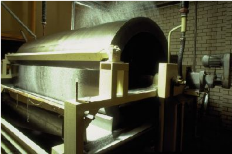
Figuur 2-12: De paraffine wordt tot een lange staaf geperst. Deze staaf wordt op de gewenste kaarslengte afgesneden.
